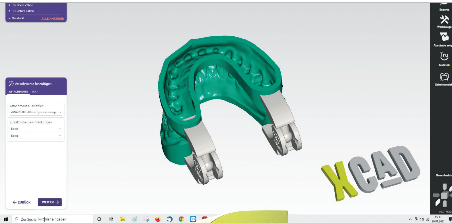
Abb. 1: xSNAP im exocad Model Creator: Das Doppelgelenk wird mit wenigen Klicks an die einander in habitueller Okklusion zugeordneten Modelle beider Kiefer angefügt. Abb. 2: Blick auf und in das xSNAP Gelenksystem. Abb. 3: Simulation von Lateralbewegungen mit xSNAP. Abb. 4: Simulation der Protrusion mit xSNAP.
