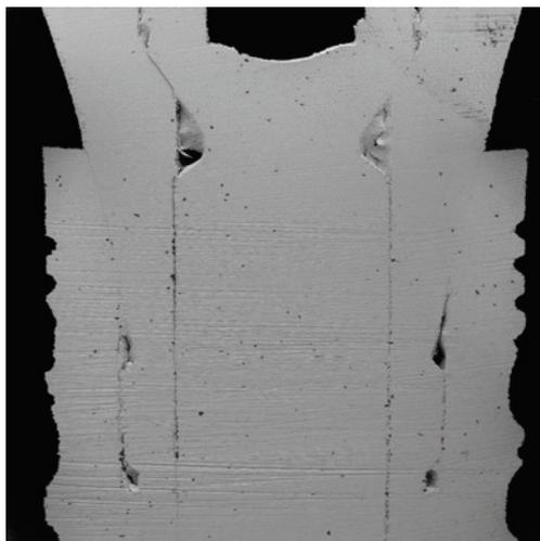
**Abb. 13:** Abutmentpassung eines BioniQ® Implantats (REM-Aufnahme, 100-fach).
