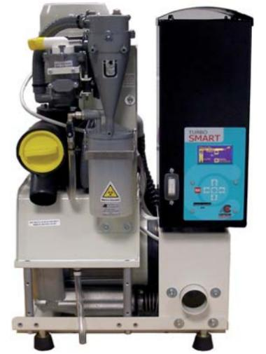
1.000 l/min bis 2.150 l/min Luftdurchsatz. In beiden Absauganlagen wurde der Amalgamabscheider Hydrozyklon ISO 18 integriert. Dieser nach dem Tornadoprinzip arbeitende Amalgamabscheider erzielt eine Abscheiderate von 98,3 Prozent bei einem Flüssigkeitsdurchsatz von 18 l/min. Selbst bei höchster Schaumbelastung, z. B. durch Blut oder Airflow, arbeitet dieser störungsfrei. ◀
