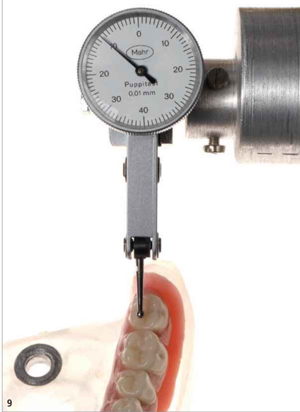
Abb. 9: Fühlhebelmessgerät zur Sattelleinsenkung. – Abb. 10: Abzugstestmaschine mit Grundmodell und Prothese (ZwickRoell).
