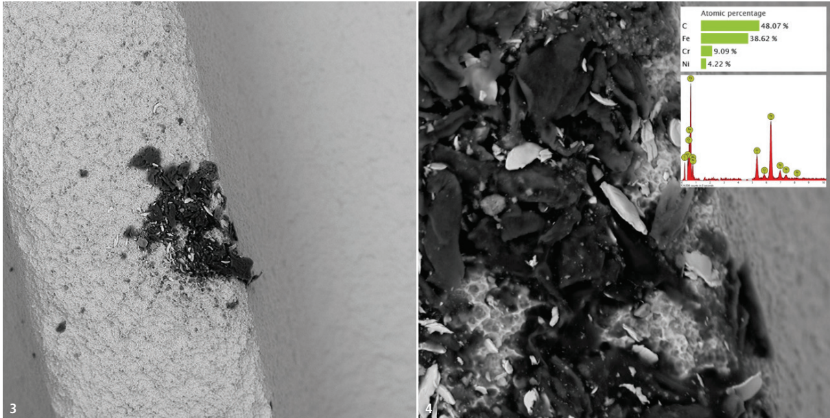
Abb. 3: Großflächige organische Verunreinigung (schwarzer Bereich) REM 500x. – Abb. 4: Darin eingebettete metallische Partikel (hellgrau), gleicher Bereich, REM 2.500x, EDX-Analyse.
