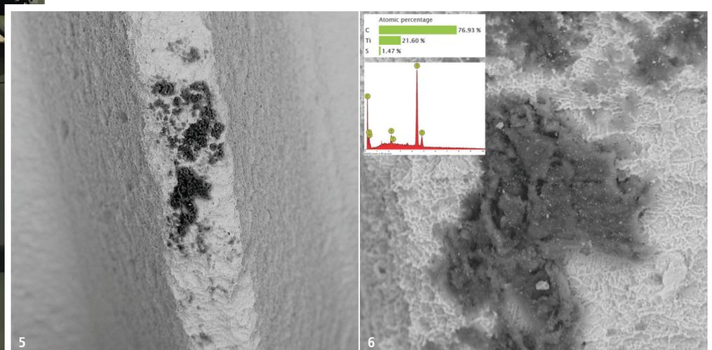
**Abb. 5:** Großflächige kohlenstoffhaltige Verunreinigung (schwarzer Bereich) REM 500x. – **Abb. 6:** Verunreinigung, REM 2.500x, EDX-Analyse. – **Abb. 7:** Time-of-Flight Secondary Ion Mass Spectrometry (ToF-SIMS) Gerät (Tascon, Münster).
