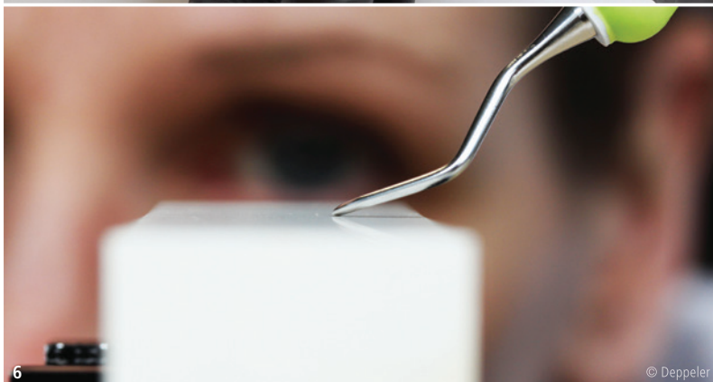
Abb. 5: Schleifen mithilfe des Easy Sharp Coach. – Abb. 6: Die Seitenfläche der Klinge sollte gut am Stein anliegen.
