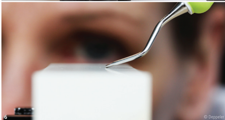
Abb. 5: Schleifen mithilfe des Easy Sharp Coach. – Abb. 6: Die Seitenfläche der Klinge sollte gut am Stein anliegen.
