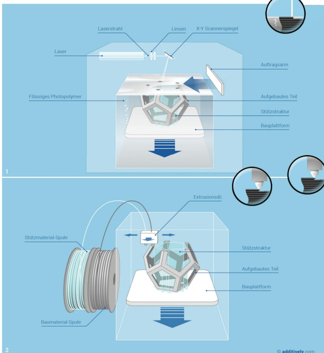
Abb. 1: Das Prinzip des SLA-Druckverfahrens. Abb. 2: Das Prinzip des FDM-Druckverfahrens. Originalscan zeigt keine Größenabweichungen.
