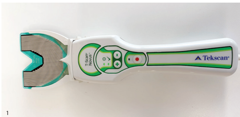
Abb. 1: Okklusionsprüfung mit dem T-Scan Novus.
