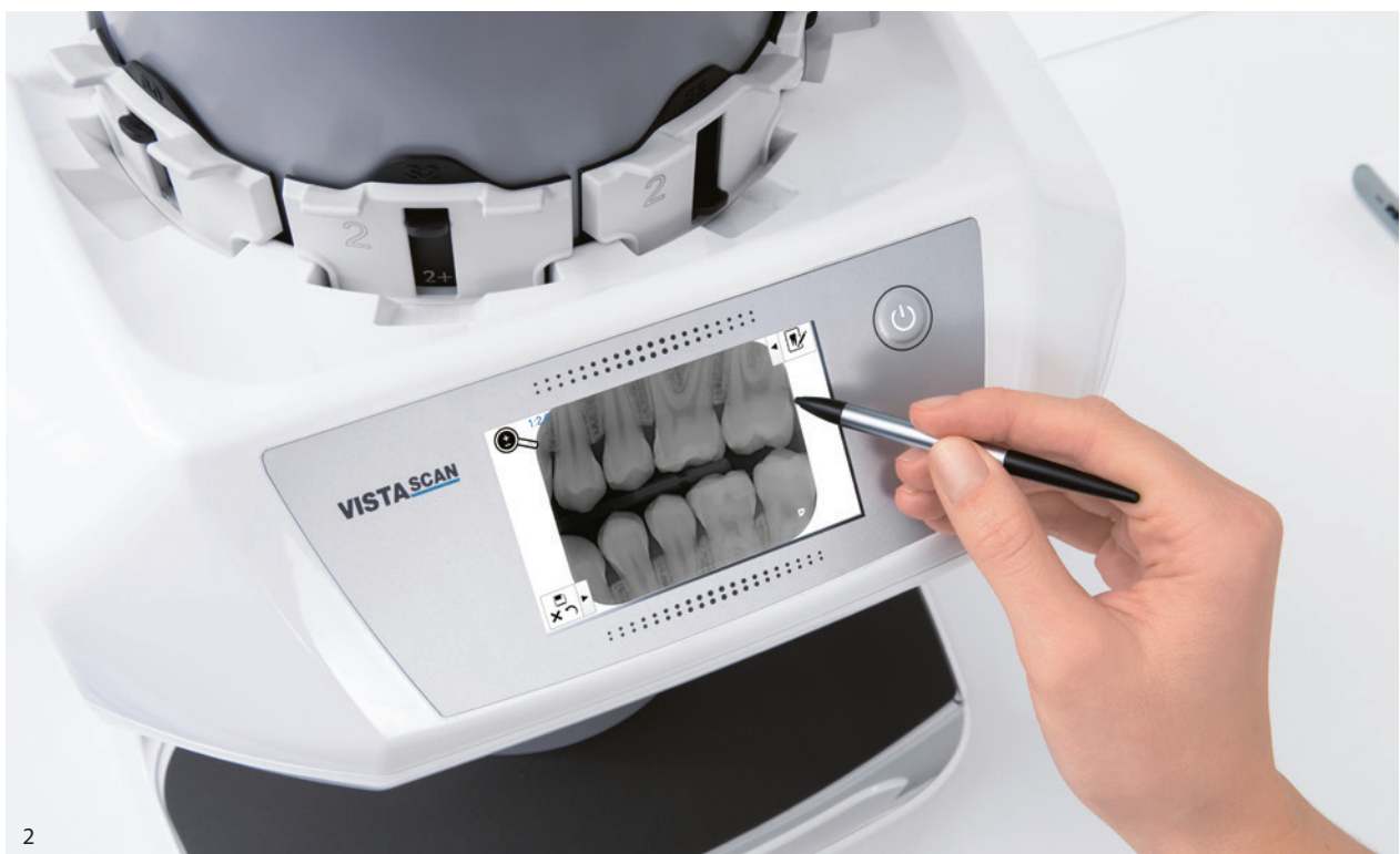
Abb. 2: Effektives Digitalisieren der Speicherfolien mit dem VistaScan Combi View für alle intra- und extraoralen Formate.
