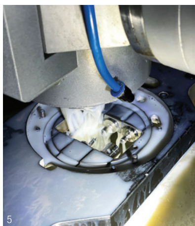
Abb. 4–6: Herstellung individueller Abutments (Implantat-Aufbauten) aus Titanrohlingen mit der Wissner Gamma 202.
