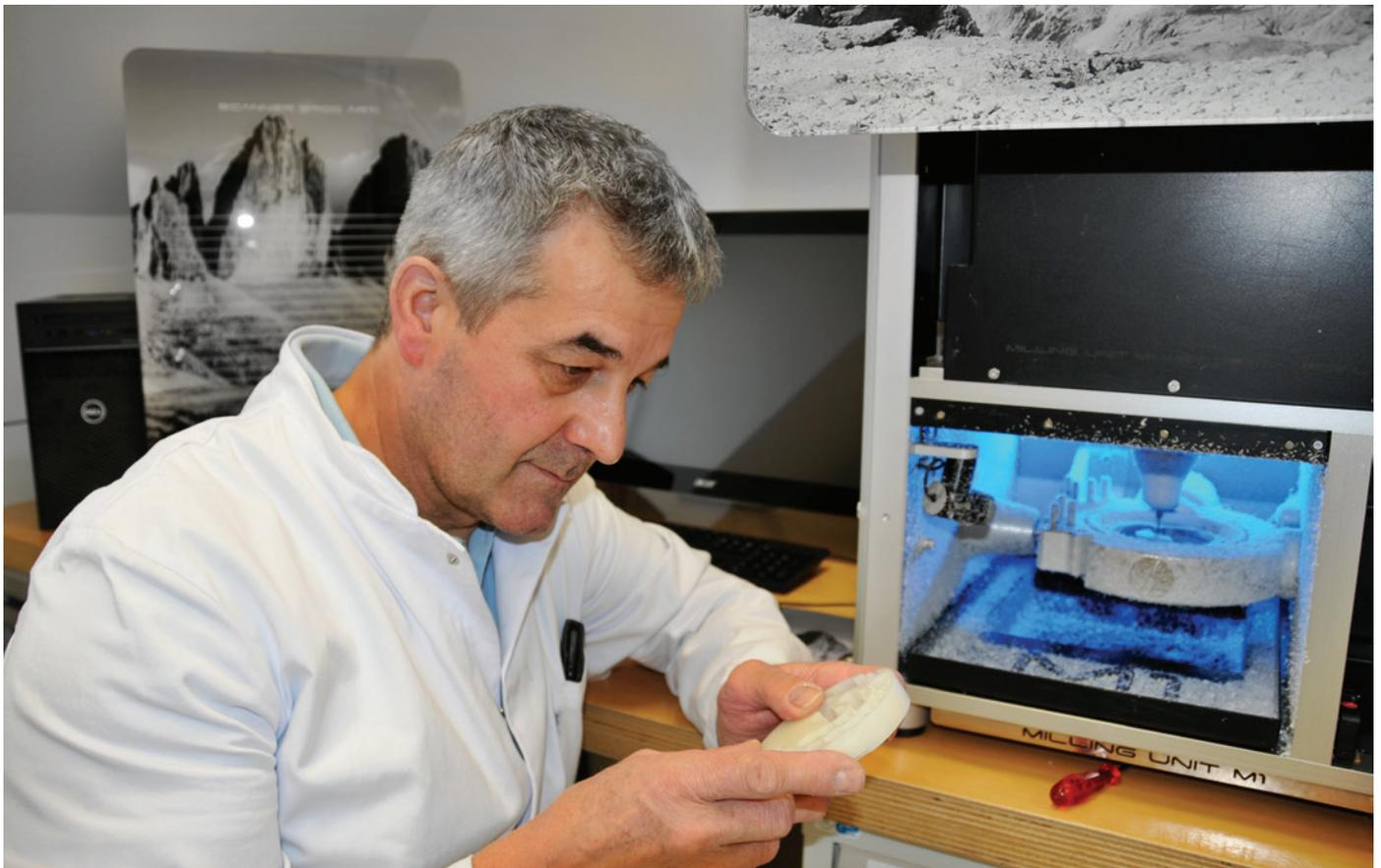
Das funktioniert hervorragend. Hier ist CAD/CAM-Kunststoff sehr erfolgreich. Vereinzelt fräsen wir auch Prothesenbasen aus Kunststoff. Es gibt verschiedene Methoden, zweiteilige, aber auch einteilige Verfahren mittels industriell gefertigten Rohlingen. Die Vorteile so eines Industrie-Rohlings sind, dass er absolut homogen ist und sich extrem gut polieren lässt. Man kann hiermit erstaunliche Ergebnisse erzielen.
