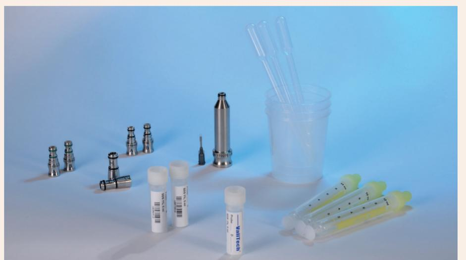
Zur Routinekontrolle der Reinigungsleistung können Übertragungsinstrumente unter Verwendung verschiedener Adapter überprüft werden.
