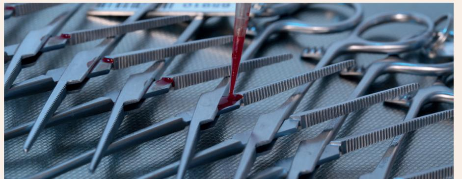
Für den Nachweis einer ausreichenden Reinigungsleistung im RDG werden definiert beschmutzte Prüfkörper eingesetzt.
