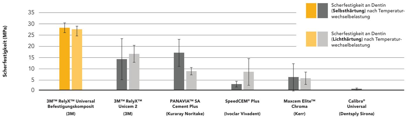
▲ **Abb. 3:** Scherfestigkeit an Dentin nach künstlicher Alterung mittels Temperaturwechselbelastung (5.000 Zyklen, 5–55 °C). (Auszug aus R. Afutu, M. Abreu, G. Kugel; Tufts University School of Dental Medicine, Boston, Massachusetts, USA, J. Dent. Res. Bd. 98A, Nr. 3629, 2019)
