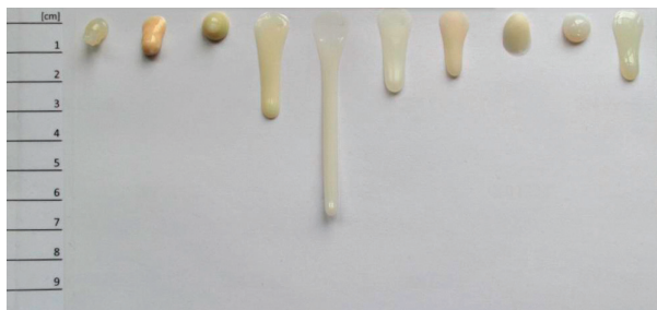
Abb. 4: Vergleich der Fließeigenschaften (ohne Druck) anhand gleich großer Mengen verschiedener Befestigungsmaterialien, die auf ein Pad appliziert und zwei Minuten senkrecht bei 36 °C gelagert sowie anschließend lichtgehärtet wurden. 3M RelyX Universal Befestigungskomposit befindet sich an dritter Stelle von links. (Foto: © 3M)
