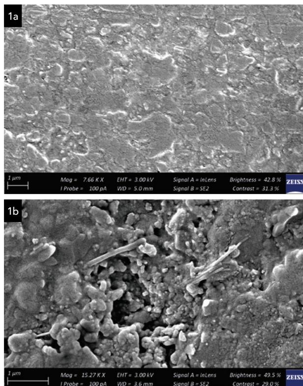
**Abb. 1a:** Die Rasterelektronenmikroskopie zeigt eine einzelne Glasphase des edelweiss CAD/CAM BLOCKS, die keine Hohlräume oder Defekte aufweist. **Abb. 1b:** Hersteller B – Handelsüblicher CAD/CAM-Block. Auf der Oberfläche sind die unregelmäßig geformten Strukturen gut zu erkennen, die eine unebene Oberfläche darstellen.
