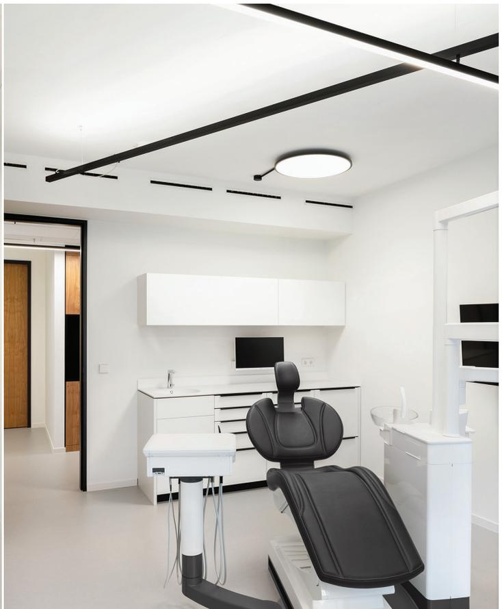
nierbaren Deckenkonstruktion. Die direkte lineare Beleuchtung betont die Längsrichtung und lenkt dennoch den Blick des Betrachters von der Decke ab. Durchdachte Details wie bündig eingelassene Sockelleisten, die in wandbündige Stahlzargen mit umlaufender Schattenfuge übergehen, unterstreichen den wertigen Charakter.
