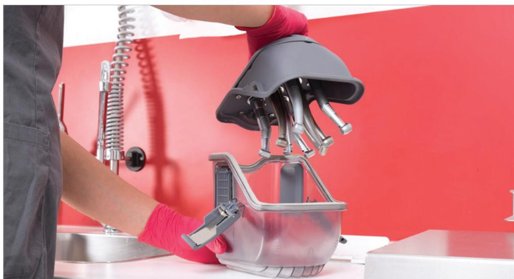
**Abb. 2:** Beladung der Carebox mit bis zu acht kontaminierten Hohlkörperinstrumenten auf der unreinen Seite des Aufbereiterungsraums.
