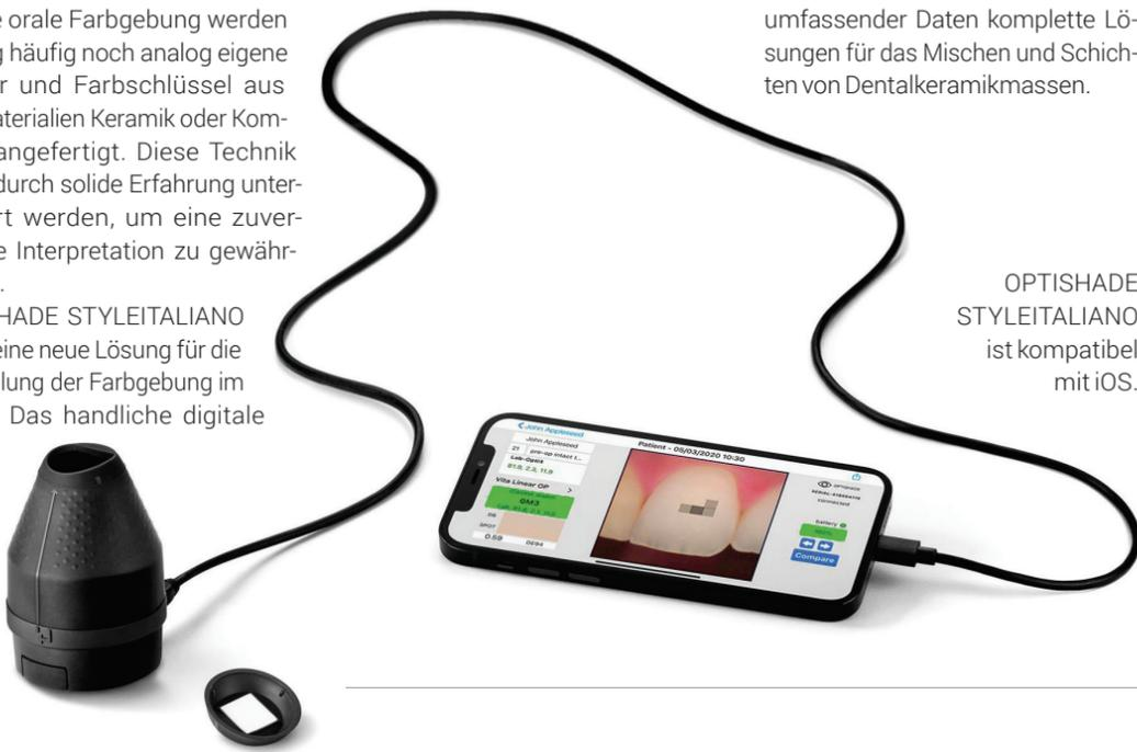
Messgerät überzeugt mit enormer Präzision und sicherer Reproduzierbarkeit. Der gemessene Farbton wird in L\*a\*b\*-Koordinaten kommuniziert, universelle Werte in der Welt der Farbmeterik, und sind damit eindeutig und von Anwendenden leicht zu interpretieren. Die L\*a\*b\*-Koor-
