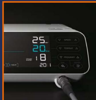
**3** Alles unter Kontrolle für einen sicheren und reibungslosen Behandlungsablauf: eindeutige, intuitiv zu bedienende Symbolsprache auf dem Bedienfeld und große, kontraststarke Parameterdarstellungen in 10 Helligkeitsstufen.
