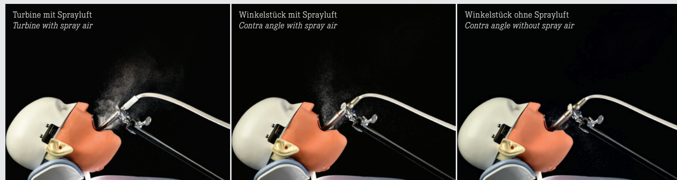
•Aerosol-Experiment mit Laserkamera. •Aerosol laser experiment.
