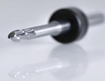
NexxZr Tool U sind dentale Hochleistungsfräser aus Premium-Hartmetall mit einer ultrascharfen Schneidkante. Die optimierte Schneidkanten- und Spanraumgeometrie ist optimal für die Bearbeitung von Zirkoniumoxid, PMMA und Wachs geeignet. Das Ergebnis sind extrem glatte Oberflächen bei harten und weichen CAD/CAM-Materialien. NexxZr Tool U überzeugt mit hoher Kantenschärfe, guter Standzeit und einem attraktiven Preis-Qualitäts-Verhältnis.
