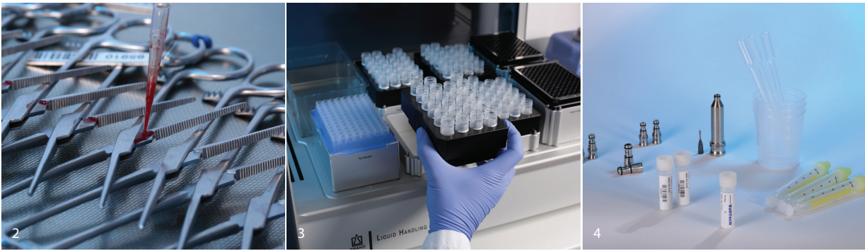
Abb. 2: Für den Nachweis einer ausreichenden Reinigungsleistung im RDG werden definiert beschmutzte Prüfkörper eingesetzt. Abb. 3: Die Auswertung der Proben für die Restproteinanalyse erfolgt im Labor nach geprüften Verfahren. Abb. 4: Zur Routinekontrolle der Reinigungsleistung können Übertragungsinstrumente unter Verwendung verschiedener Adapter überprüft werden.
