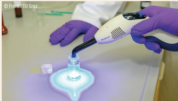
Photoinitiatoren auf Germaniumbasis brauchen nur sichtbares Licht, um zu zerfallen und so für die Aushärtung von Kunststoffpasten zu sorgen.
