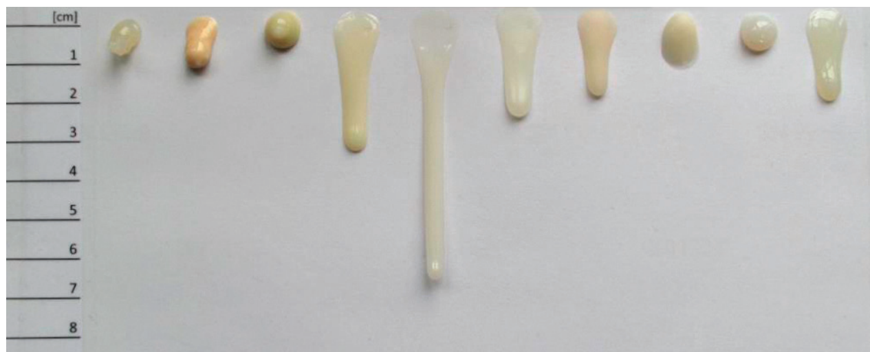
Abb. 4: Vergleich der Fließeigenschaften (ohne Druck) anhand gleich großer Mengen verschiedener Befestigungsmaterialien, die auf ein Pad appliziert und zwei Minuten senkrecht bei 36 °C gelagert sowie anschließend lichtgehärtet wurden. 3M RelyX Universal Befestigungskomposit befindet sich an dritter Stelle von links. (© 3M)
