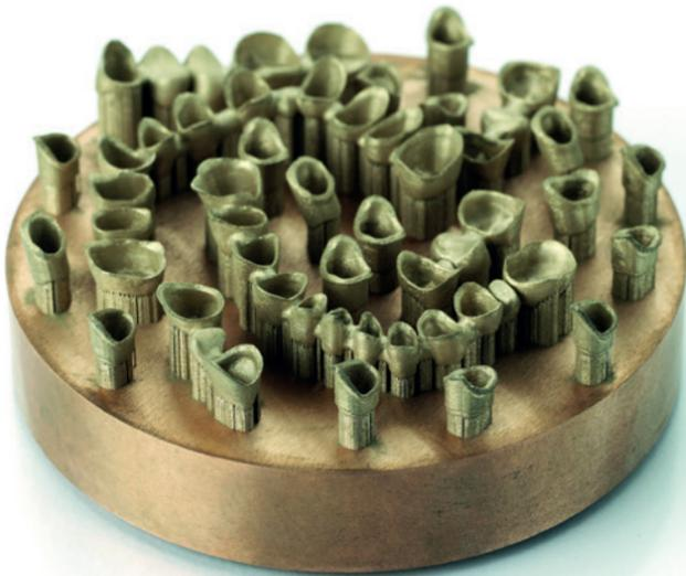
C.HAFNER verfügt über eine eigene Verdünnungsanlage zur Herstellung von Edelmetallpulvern höchster Reinheit und Güte. Diese Pulver bilden die Basis für den eigentlichen Fertigungsprozess auf den 3D-Druckmaschinen.
