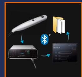
**3** Erweiterte Datenverwaltung, dank Bluetooth®-Verbindung zum chirurgischen Mikromotorsystem Surgic Pro2. Diese ermöglicht die Übermittlung und Speicherung des ISQ-Werts über eine gemeinsame Schnittstelle.
