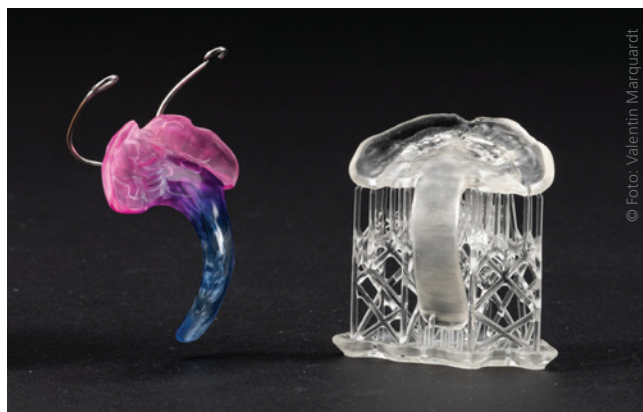
Diese futuristisch anmutenden Gaumenplatten werden mittels 3D-Druckverfahren produziert.
