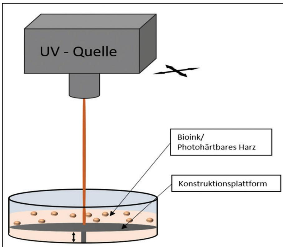
**Abb. 1:** Für die Vat-Photopolymerisation wird sich die Eigenschaft photosensibler Materialien, bei Absorption von UV-Licht auszuhärten, zunutze gemacht, um mittels zielgerichteter UV-Bestrahlung die benötigten Konstrukte herzustellen.
