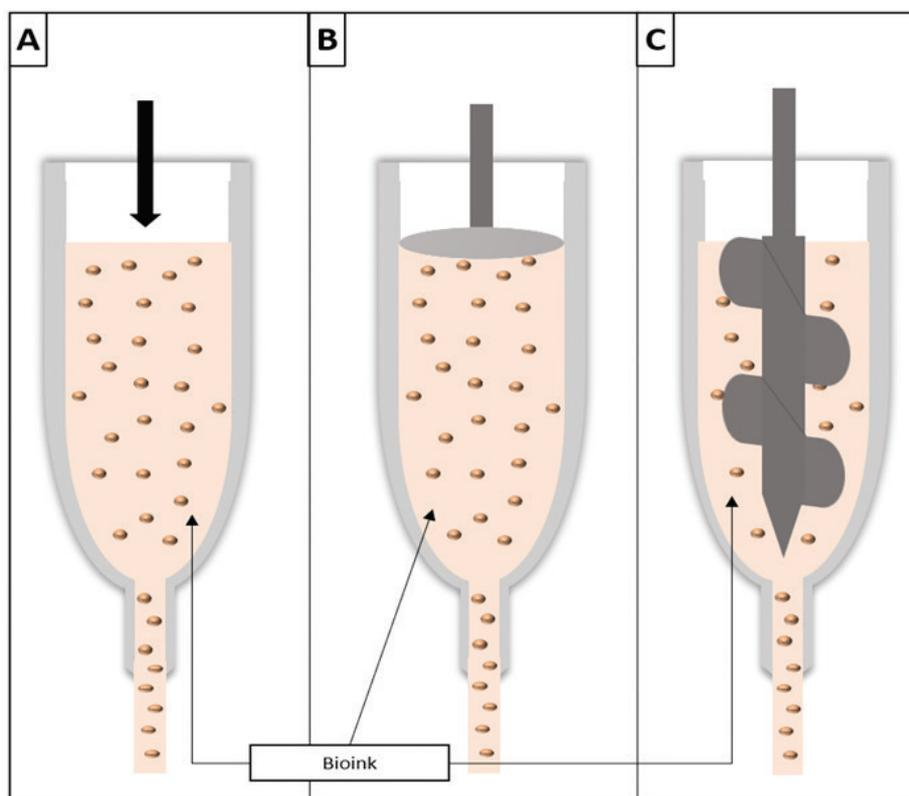
**Abb. 3:** Extrusionsdrucker nutzen verschiedene Mechanismen, wie Druckluft (A), mechanische Kolben (B) oder motorisierte Schrauben (C), um die Bioink aus dem Düsenkopf auszustößen. Auf diese Weise wird Schicht für Schicht das gewünschte Objekt gefertigt.
