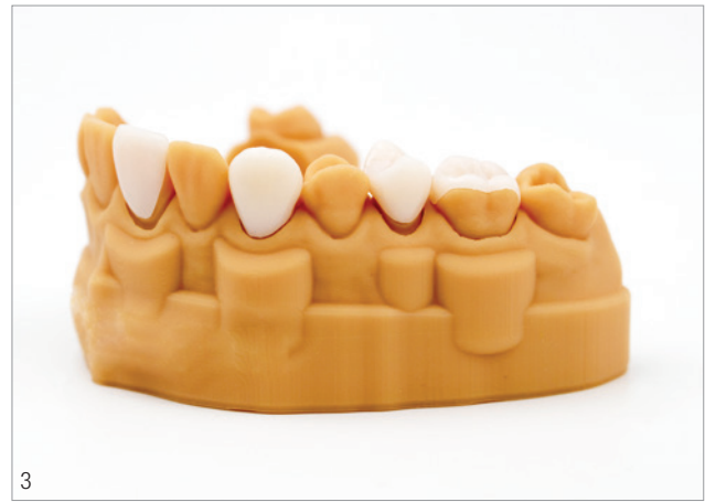
Abb. 1: Bauplattform eines D30+ 3D-Druckers von Rapid Shape in der Größe 130 x 75 mm. Abb. 2: Zahnmodell mit 3D-gedrucktem und poliertem Zahnersatz. Abb. 3: Zahnmodell bestückt mit 3D-gedruckten, gereinigten, ausgehärteten und polierten Veneers sowie Kronen und Onlays/Inlays. Abb. 4: 3D-Druck-Systeme machen den täglichen Arbeitsablauf im Dentallabor schnell, einfach, sicher und sauber.
