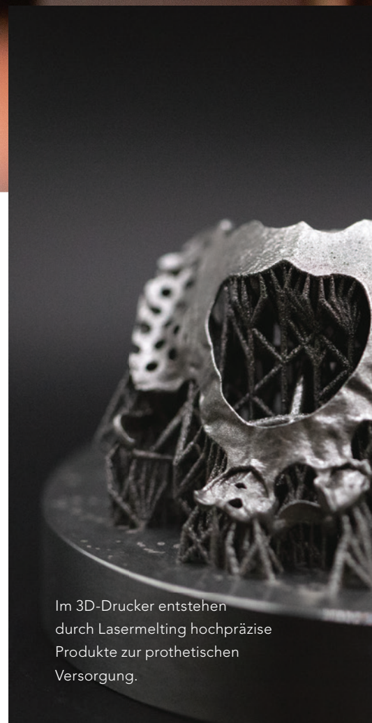
Frisch gedruckt: Zahntechnik aus dem 3D-Drucker.
