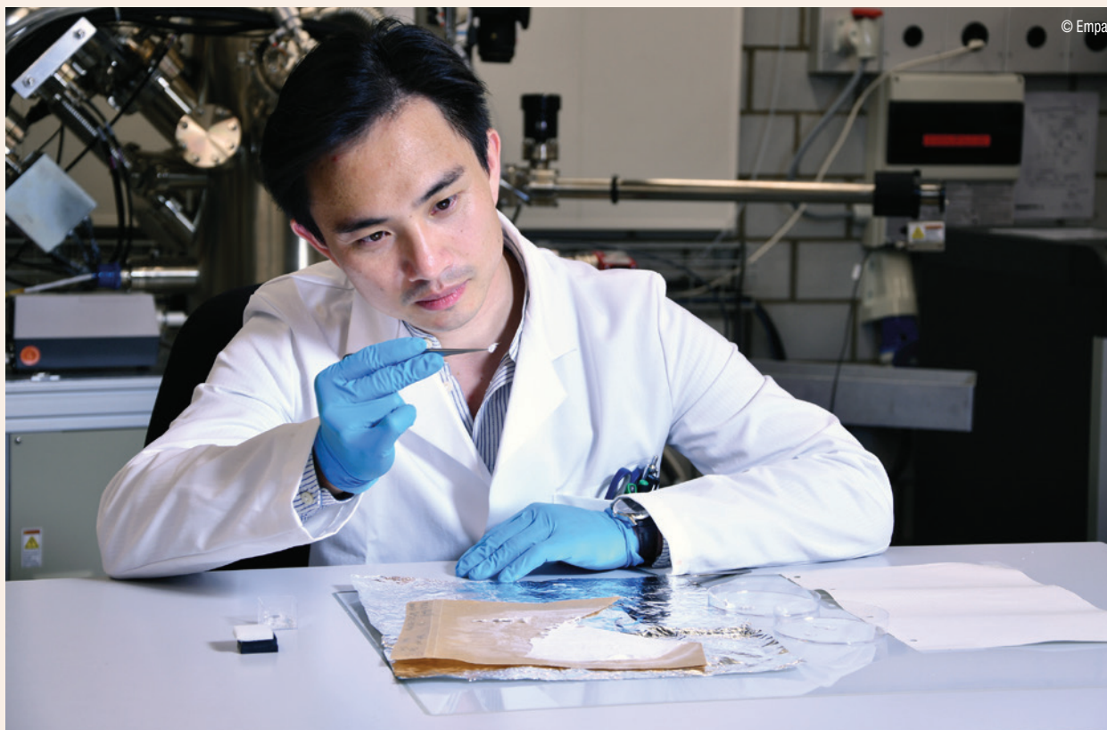
Empa-Forscher Fei Pan arbeitet an einer Membran aus Nanofasern, die Medikamente nur dann abgibt, wenn sich das Material erwärmt. Eine derartige Membran könnte etwa in einem Verband aktiv werden, sobald sich eine Wunde entzündet.
