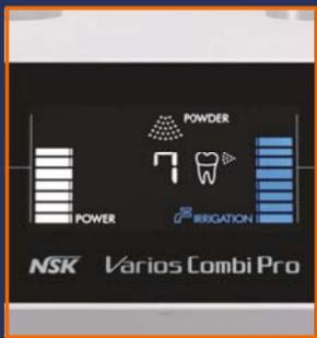
**1** Intuitive Bedienung. Symboltasten für die wichtigsten Funktionen verleihen große Sicherheit und zeigen auf einen Blick an, welche Anwendung (Ultraschall, supragingivale oder subgingivale Anwendung) und welche Einstellungen (Intensität, Sprayvolumen) aktiviert sind.
