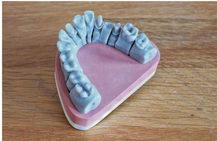
Mit der Software didex von dentona AG lassen sich PINDEX-Modelle im 3D-Druckverfahren herstellen. Die Handhabung ähnelt dem klassischen Vorgehen, nur eben auf digitalem Weg. Dabei verfolgt didex einen einzigartigen Ansatz: Die bewährte Arbeitsgrundlage „Sägeschnittmodell“ wird nicht ersetzt, sondern in den digitalen Workflow integriert. So lässt sich die Arbeit im Gipsraum digitalisieren, ohne auf probate Grundlagen verzichten
