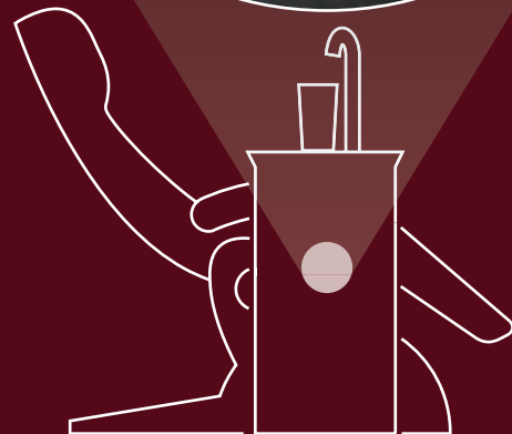
Sicherungseinrichtung „Freie Fallstrecke“ nach DIN EN 1717
