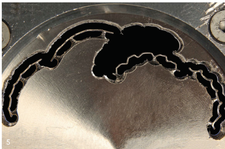
Abb. 5: Gefräster Retainer. – Abb. 6: Gefräster Retainer auf Modell.
