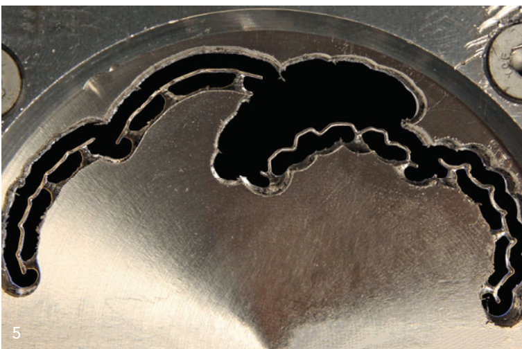
Abb. 5: Gefräster Retainer. – Abb. 6: Gefräster Retainer auf Modell.
