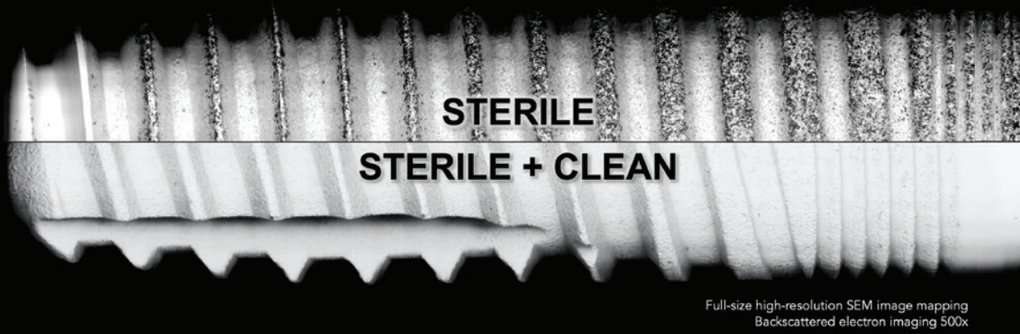
Abb. 1: Ein REM-Bild der Oberfläche von zwei Implantaten, die vor dem Einsetzen aus der Verpackung genommen wurden: Obwohl beide Oberflächen steril sind, weist eine davon erhebliche Ablagerungen aus der Implantatherstellung auf, die die Osseointegration beeinträchtigen können.
