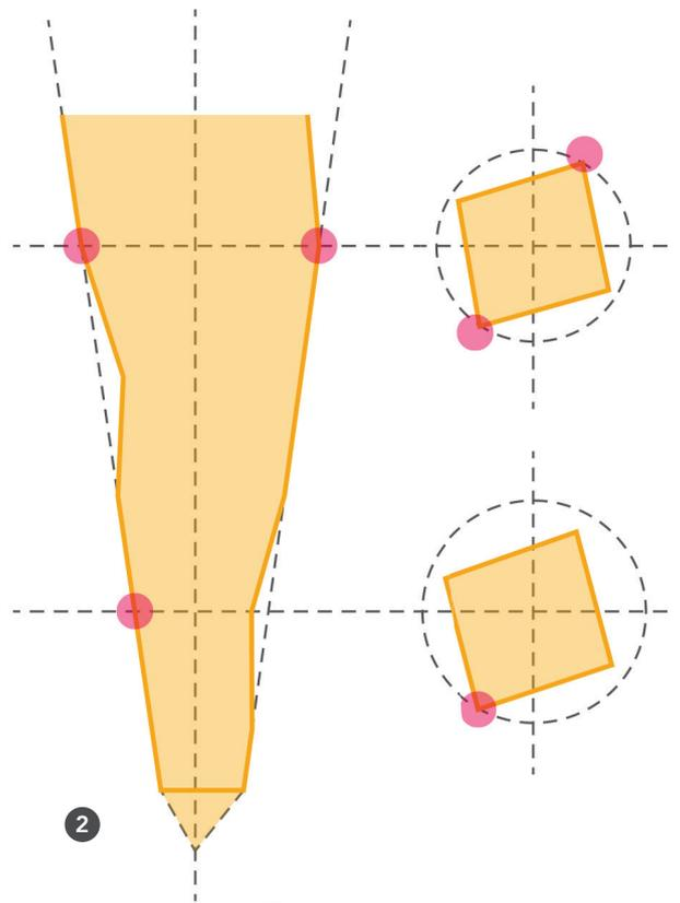
**Abb. 2:** Flexible und ermüdungsresistente Feile mit einem nicht ganz symmetrischen Querschnitt und einem daraus resultierenden wichtigen Vorteil: Das Massenzentrum ist nicht gleich dem Rotationszentrum, was den Stress auf das Material während des Schneidvorgangs reduziert und mehr Platz für den Abtransport von Debris lässt.
