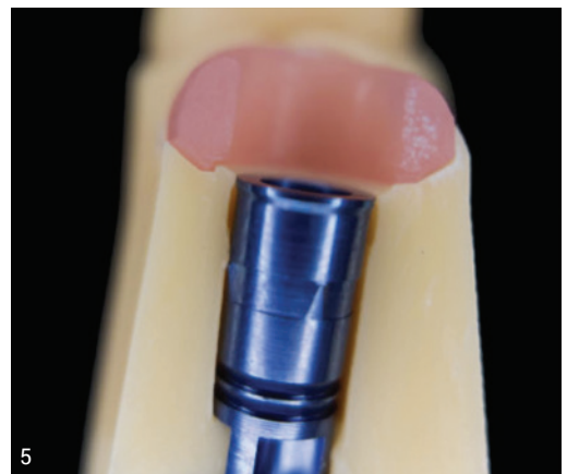
Abb. 2: Oberflächenscan als .stl. Abb. 3: Geometrie Fixationsbereich Elos Accurate® PMA. Abb. 4: Elos Accurate® im gedruckten Modell. Abb. 5: Gedrucktes 3D-Modell im Querschnitt. (Fotos: © INFINIDENT)
