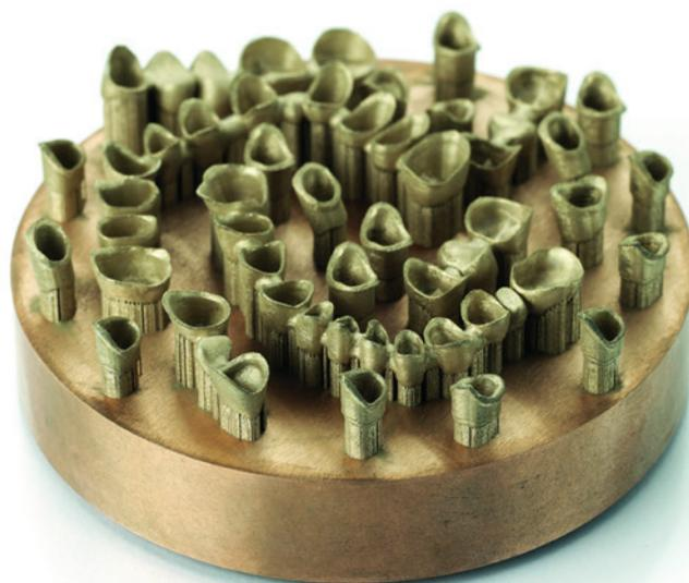
druckt. Hierzu ist es notwendig, die erforderlichen Fräsrohlinge und das Pulver aus Edelmetall in einer entsprechend hohen Qualität herzustellen und mit speziell angepassten Fräs- und Druckstrategien sowie Werkzeugen zu bearbeiten.
