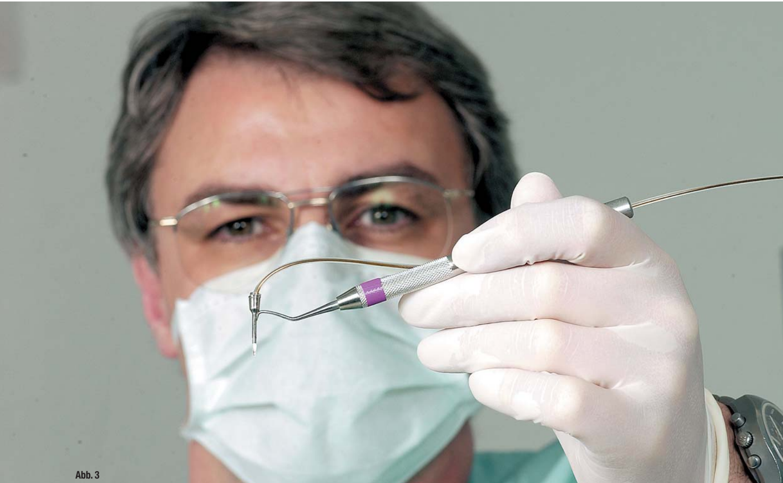
Abb. 3 _ Die nur 1 mm große optische Kamera.
