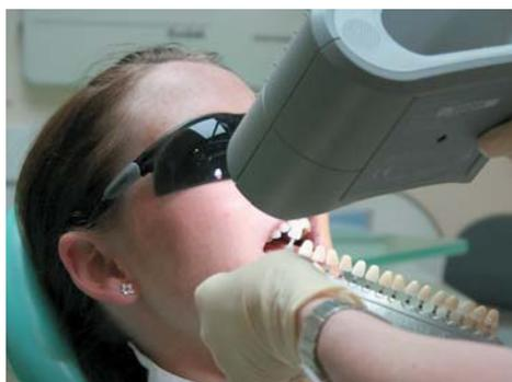
Optilume Trueshade ist mit seinem farbkorrigierten Diodenlicht speziell für die zahnmedizinische Farbnahme entwickelt worden. Das Gerät nutzt eine Kombination aus RGB-farbigem LEDs und erzeugt so die korrekten Wellenlängen des sichtbaren mittäglichen Tageslichts. Ein integriertes Kühlsystem vermeidet exzessive Hitzeentwicklung. Damit setzt das Farbnahmegerät einen neuen Standard in der ästhetischen Zahnheilkunde.
