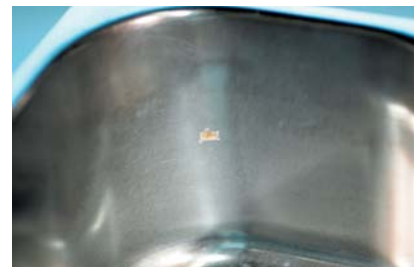
Abb. 1: Die exakte Zeitdauer der Ultraschallreinigung muss genau eingehalten werden. (Arbeitsanweisung). – Abb. 2: Dabei ist darauf zu achten, dass der „Pegel“ stimmt. Über der „Minimum“- und unter der „Maximum“-Markierung für den Flüssigkeitsstand. – Abb. 3: Roststelle? Oder Verschmutzung? In der Wanne des Ultraschallgerätes toleriert der Prüfer keins von beiden.
