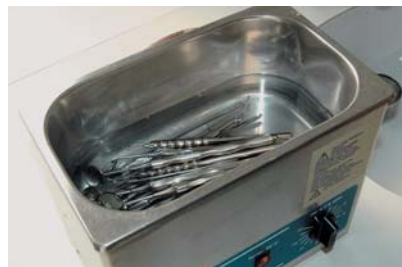
Abb. 1: Die exakte Zeitdauer der Ultraschallreinigung muss genau eingehalten werden. (Arbeitsanweisung). – Abb. 2: Dabei ist darauf zu achten, dass der „Pegel“ stimmt. Über der „Minimum“- und unter der „Maximum“-Markierung für den Flüssigkeitsstand. – Abb. 3: Roststelle? Oder Verschmutzung? In der Wanne des Ultraschallgerätes toleriert der Prüfer keins von beiden.
