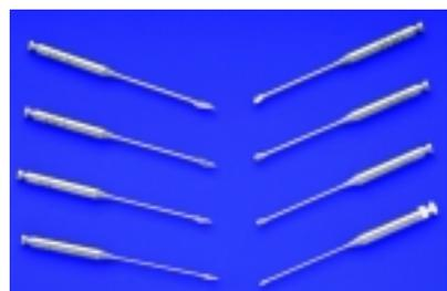
Abb. 3: Das iRS ist ein Instrumentarium, um abgebrochene Instrumente einzuklemmen und zu entfernen. Jedes iRS enthält ein Mikroröhrchen und einen Schraubkeil von unterschiedlichem Durchmesser. – Abb.4: Das PRS Kit enthält fünf verschiedene große Trepan-Bohrer und entsprechende Schachtschneider, einen Schneidbohrer für Metall, einen Gummipuffer, eine Drehstange und eine Extraktionspinzette. – Abb. 5: Das Foto zeigt die ausgewählten GG-Bohrer und deren nachfolgende Modifikation.
