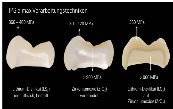
Abb. 3: V.l.n.r.: Vollanatomisches LS 2 -Kronendesign, ZrO 2 -Gerüst mit Schichtkeramik, ZrO 2 -Gerüst mit CAD-Kaufläche aus LS 2 -Keramik.
