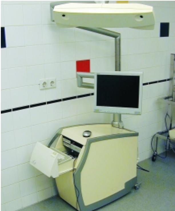
Abb. 3: Das Gerät des IGI, bestehend aus Corpus mit 2 PC, Bildschirm, Halterung mit 2 Positionskameras, Anschlüsse für Handstück- und Schienensensoren, Fußschalter.
