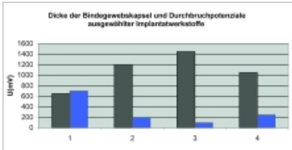
Zusammenhang Dicke der fibrosen Kapsel und Durchbruchpotenzial verschiedener Werkstoffe.
