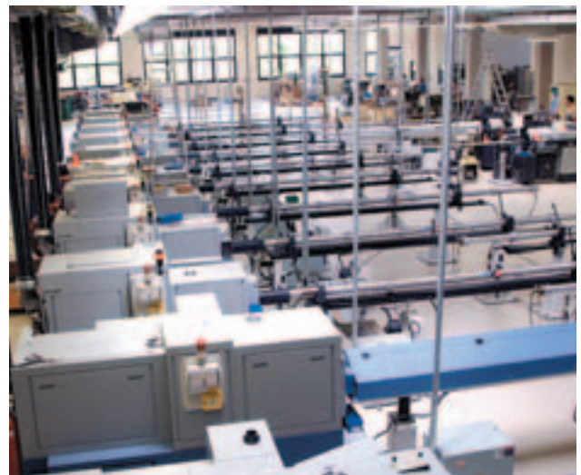
Bis zu 60 Drehautomaten finden im Maschinensaal der Camlog-Produktion Platz. Foto: Camlog AG
