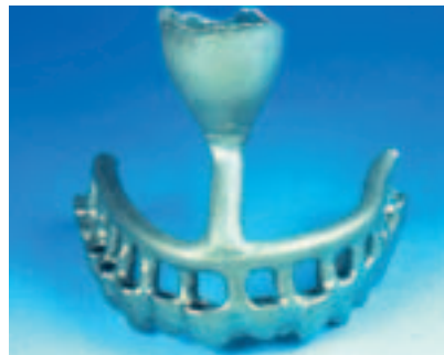
Abb. 1: Labor-Laserschweißgerät (Desktop compact, Dentaforum). – Abb. 2: Gegossene Titansuprastruktur (Rohguss). – Abb. 3: Vergleich Korrosionsfestigkeit Löten – Schweißen. 2
