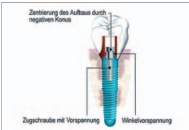
Abb. 1: Die Querschnittszeichnung verdeutlicht, dass das BPI-Easy-Fit-Implantat nicht nur anatomisch ästhetisch gestaltet ist, sondern die Abutmentbefestigung technisch neu gelöst ist.
