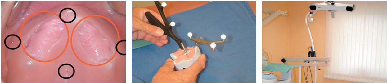
Abb. 10: Die schwarzen Kreise bezeichnen die Metallmarker, die roten die für die Implantation ausgesparten Bereiche. – Abb. 11: Vor der Operation wird das System geeicht. Mit einer feinen Spitze werden die Metallmarker angetippt, um dem System die Lager der Schablone im Raum zu vermitteln. Ebenso wird mit dem Winkelstück verfahren; es werden verschiedene intraoperativ benötigte Bohrer eingemessen. – Abb. 12: Es ist darauf zu achten, dass das Navigationssystem freie „Sicht“ auf die Übertragungskugeln hat. Jede Unterbrechung unterbricht auch kurzzeitig die Übertragung.
