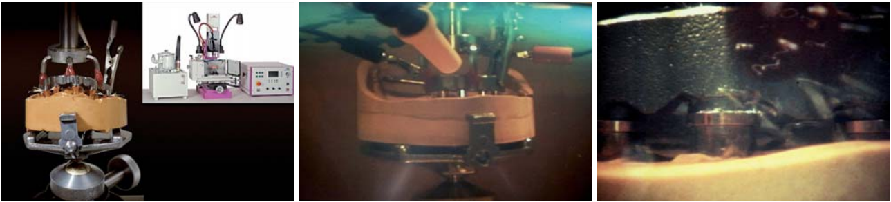
Abb. 6: Die Passungsoptimierung der Mesostruktur in der SAE-Funkenerosionsmaschine. Das Modell mit den Kupferelektroden – vorbereitet für den Erosionsprozess zur Passivierung der Mesostruktur. – Abb. 7: Der Funkenerosionsprozess. Die Aufnahmekralle mit der Mesostruktur bewegt sich in Z-Achsen-Richtung auf das Modell mit den Elektroden zu. Gleichzeitig umspült in der Wanne eine Flüssigkeit (Dielektrikum) zur Kühlung und Reinigung sowie zur Optimierung der elektrischen Leitfähigkeit das Erosionsobjekt. Bei Annäherung der Implantatstruktur erfolgt durch die Kurzschlussimpulse der Funkenüberschlag. – Abb. 8: Dieser bewirkt den Abtrag an den Stellen der Stegstruktur, die punktuell aufsitzen und zu erst elektrischen Kontakt bekommen. Der Prozess setzt sich bis zum gleichmäßigen Kontakt der Struktur auf den Elektroden fort, bis die Struktur auf den Implantatanalog zirkulär voll aufsitzt.
