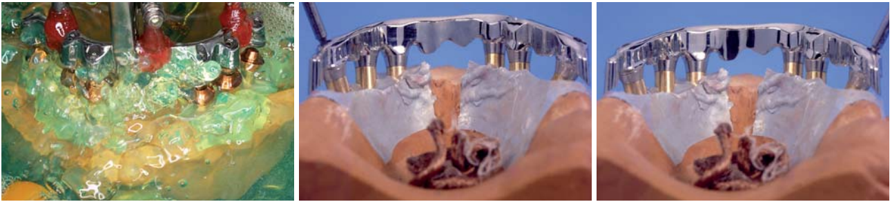
Abb. 26: Der Funkerosionsprozess auf Kupferelektroden im Dielektrikum. – Abb. 27 und 28: Der Sheffield-Test zeigt die spannungs- und spaltfrei aufsitzende Stegstruktur nach der Funkerosion.
